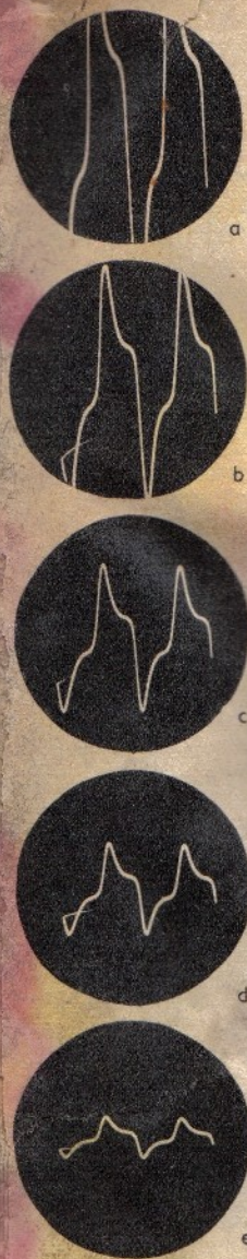
Abb. 5. Wahl der günstigsten Bildhöhe. a) und b) Bildhöhe wird überschritten, c) günstige Einstellung, d) noch brauchbar, e) zu niedrige Höhe läßt zu wenig Einzelheiten erkennen
