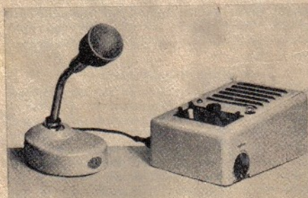
Abb. 4. Dynamisches Mikrofon und Fernbedienungsgerät des Stahltongerätes LDG 1
